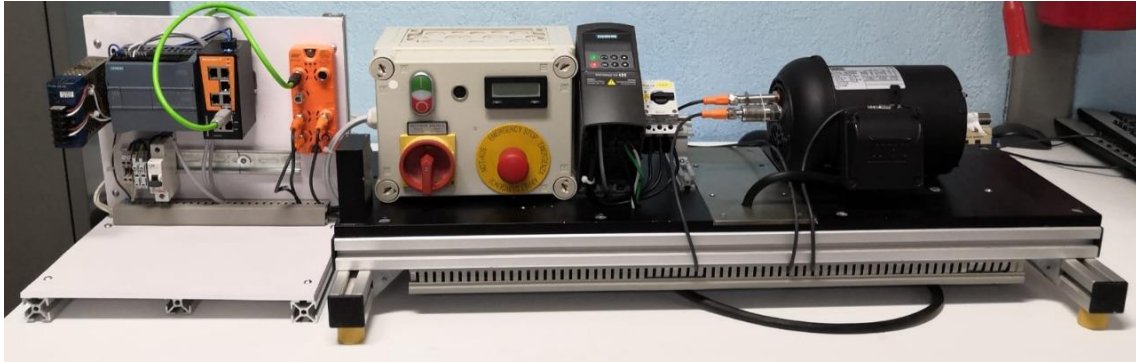
Figura 18. Banco de pruebas de motores de inducción, montaje final.
