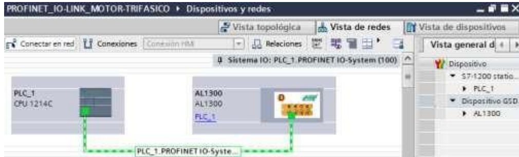
Figura 6. Configuración de la Red de comunicación Profinet.
