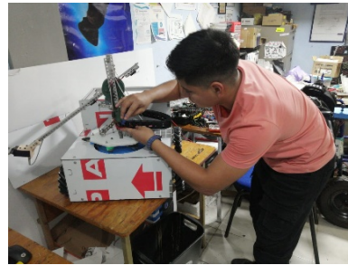
Figura 16. Proceso final del recubrimiento y montaje del brazo robótico de 3 grados de libertad.
