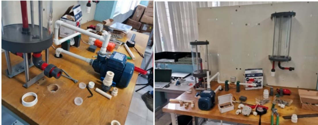
Figura 13. Montaje de bomba y conexión de tubería de succión y salida.
