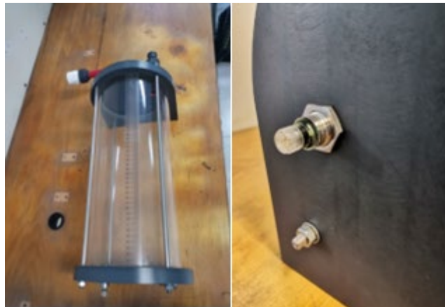
Figura 11. Reacondicionamiento e instalación de sensor ultrasónico en el tanque 1.
