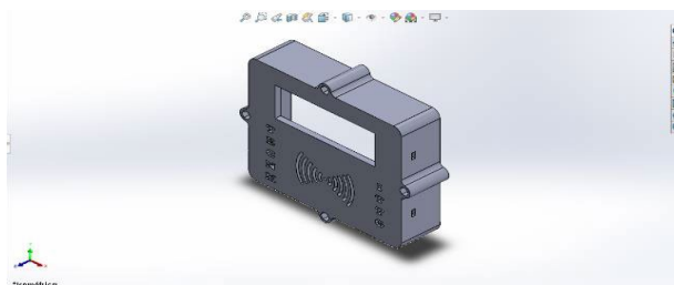
Figura 14. Carcasa para el RFID RC522.
