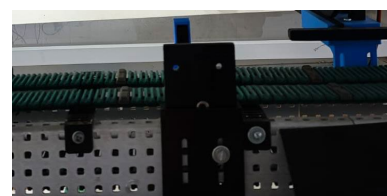
3) Colocando las bases de sensor.
