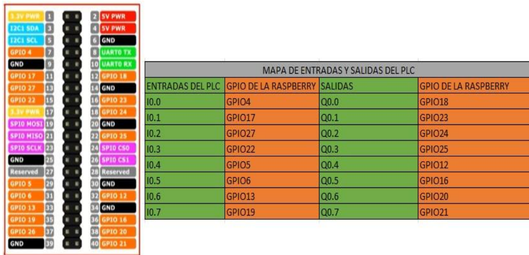
Figura 9. Distribución de las GPIO de la Raspberry PI con respecto a los módulos de E/S del PLC.
