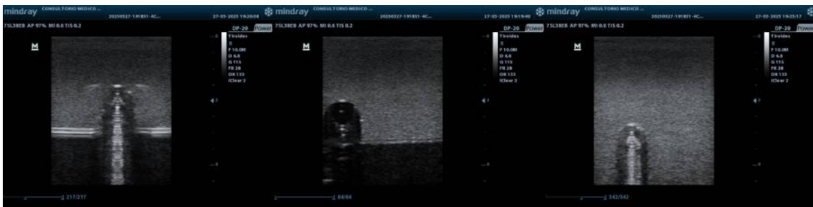
Figura 8. Phantom con inserción de objeto conocido (canica de 0.96 cm).
