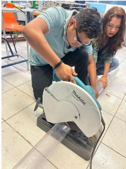
Figura 14. Corte del tubo de policarbonato.
