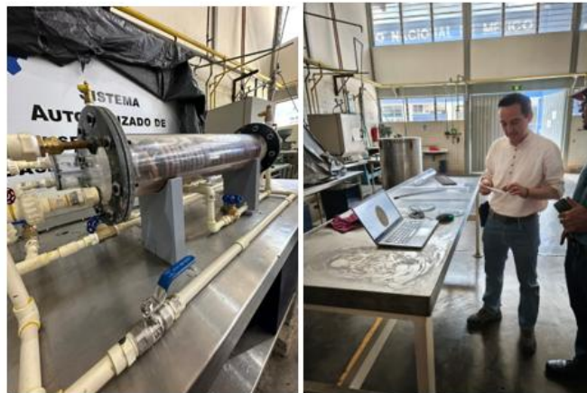
Figura 16. Ensamble final del intercambiador de calor tipo serpentin.
