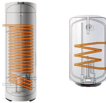
Figura 1. Esquema intercambiador de calor tipo serpiente.
