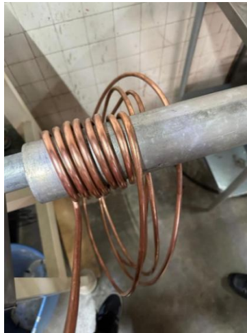
Figura 7. Doblado de tubo para la fabricación del serpentín.
