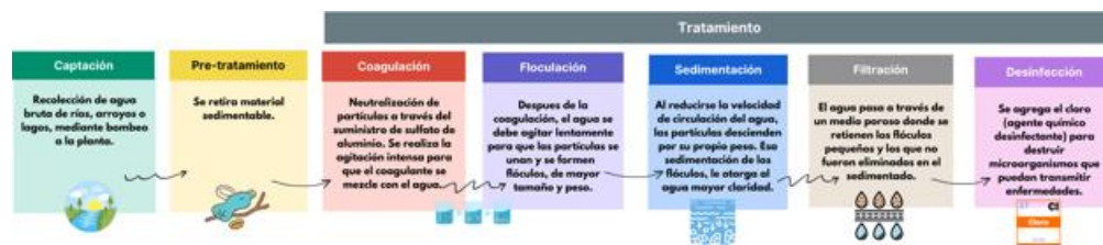
Figura 5. Proceso de potabilización.
