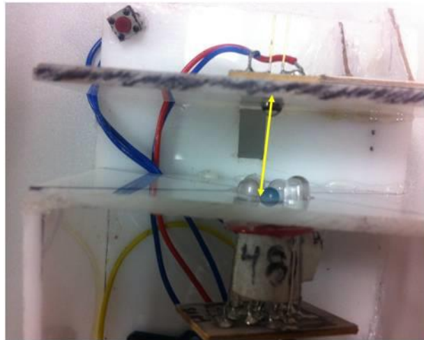
Figura 2. Distancia óptima entre el fotodiodo y la fuente de luz.
