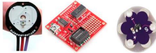
Figura 2. Sensores: a) sensor de pulso, b) Polar heart rate, c) sensor de temperatura.
