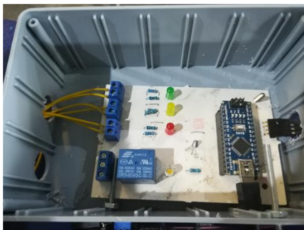
Figura 18. Placa electrónica con salida analógica y digital.
