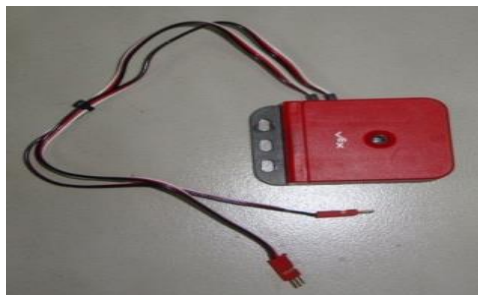
Figura 2. Encoder de cuadratura marca VEX ROBOTICS.
