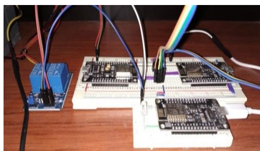
Figura 9. Circuito físico con NodeMCU implementado.
