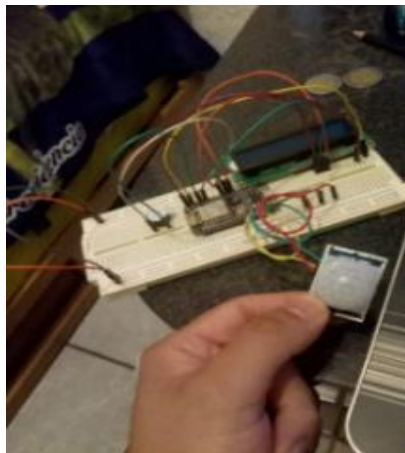
Figura 4. Sensor montado en protoboard .
