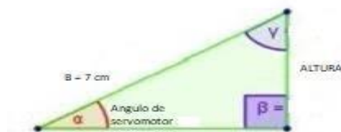
Figura 7. Altura de levantamiento de cada pata
