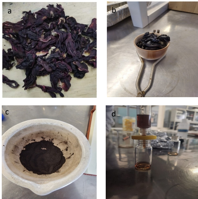
Figura 1. a) flor de jamaica seca, obtenida en comercio local, b) proceso de carbonización, c) maceración y obtención de polvo fino de carbón, d) filtrado de las nanopartículas de carbón.
