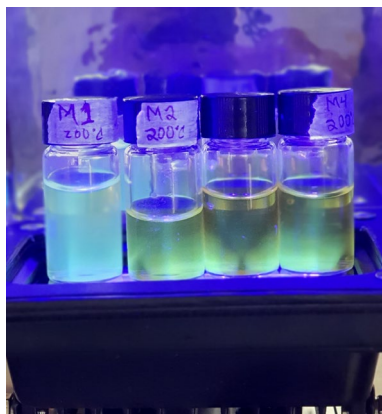
Figura 2. a) nanopartículas de carbón bajo luz UV emiten fluorescencia en el color verde.
