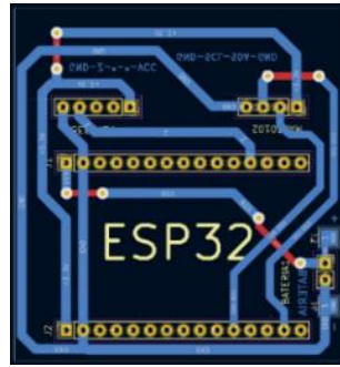
Figura 1. Diseño de la placa de circuito impreso (PCB) con microcontrolador ESP32 y sensores de adquisición.
