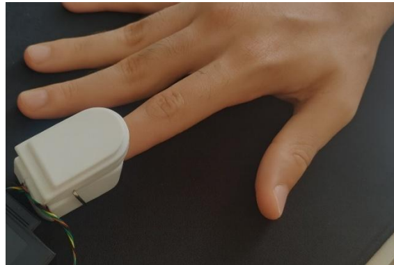
Figura 3. Sensor óptico MAX30102 colocado en el dedo índice para adquisición PPG.
