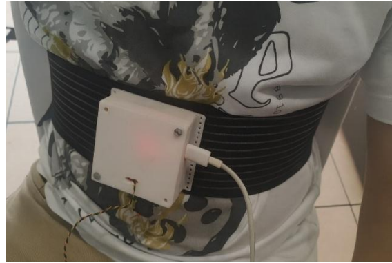
Figura 2. Banda torácica impresa en 3D con sensor ADXL335 para registro respiratorio.
